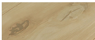
Паркетная доска с дефектом, заделанным Новорит-Фортэ, после шлифования
